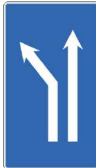
S-60a Bifurcación hacia la izquierda en calzada de dos carriles
