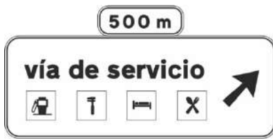
S-264 Preseñalización en carretera convencional de una vía de servicio
