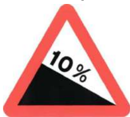
P-16a Bajada con fuerte 31 pendiente
