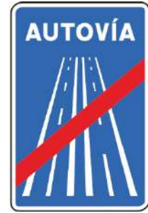
S-2a Fin de autovía
