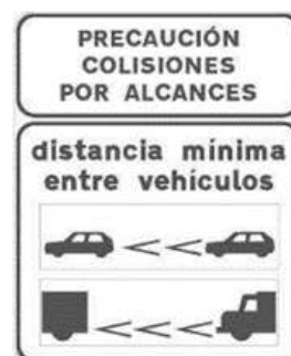
Cartel situado antes de túnel en carreteras convencionales
