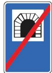
S-6 Fin de túnel
