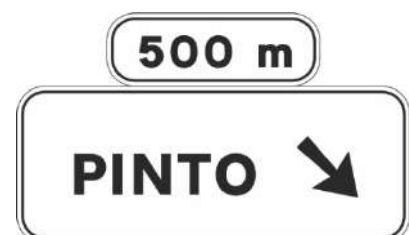
S-230 Preseñalización con señales sobre la calzada en carretera convencional hacia carretera convencional
