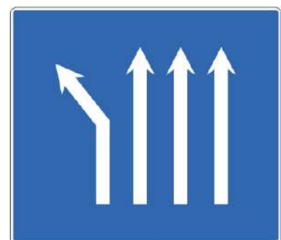
S-62a Bifurcación hacia la izquierda en calzada de cuatro carriles
