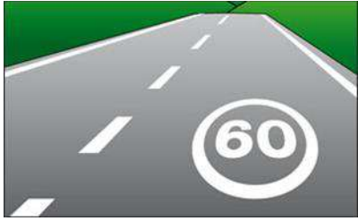
Señal de limitación de velocidad
