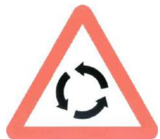
P-4 Intersección con circulación giratoria
