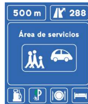
S-271 Preseñalización de área de servicio
