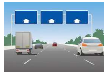
Marca longitudinal discontinua (de separación carriles)
