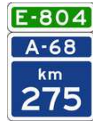
S-571 Hito kilométrico en autopista y autovía que, además, forma parte de un itinerario europeo
