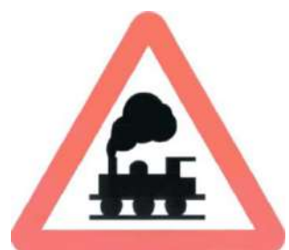
P-8 Paso a nivel sin barreras
