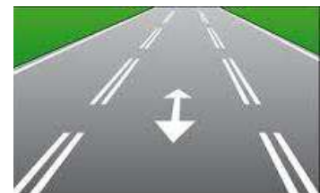
Marcas longitudinales discontinuas dobles
