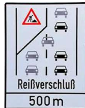
Señal en Alemania que indica que deben alternarse los vehículos que
