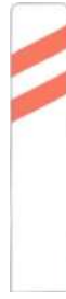
P-9b Aproximación a un paso a nivel, puente móvil o muelle (lado derecho)
