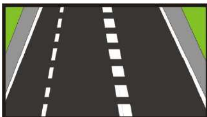
Marca longitudinal discontinua (carril de incorporación y salida y carril tráfico lento)
