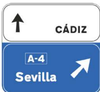
222a Preseñalización de direcciones hacia una autopista o una autovía y dirección propia
