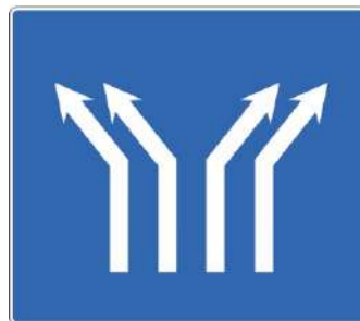
S-63 Bifurcación en calzada de cuatro carriles
