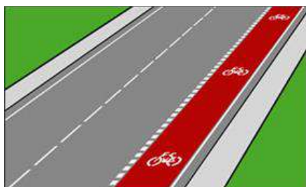
Vía ciclista próxima a intersección con carretera 67
